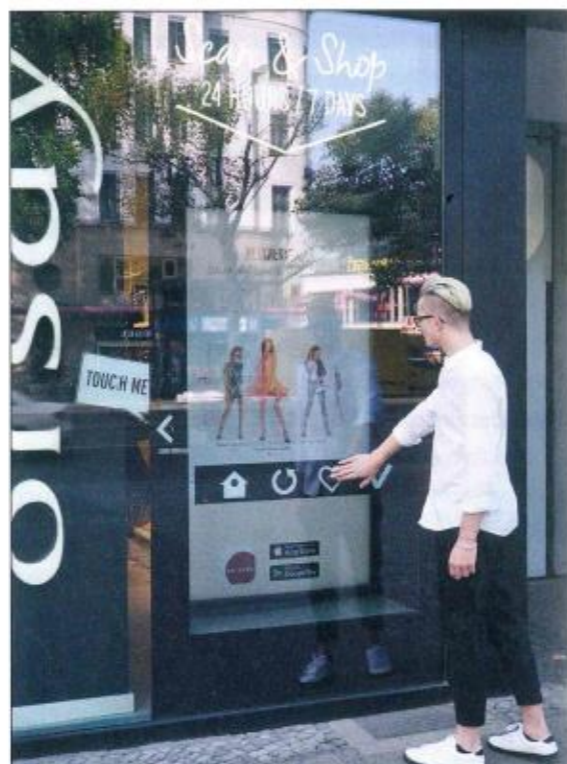
Storefront-Control funktioniert durch bis zu 40 Millimeter starke, dreifach verglaste Scheiben.
